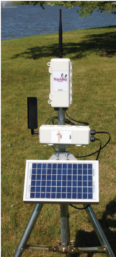
Módem celular DataScout 3928M montado con un receptor WatchDog
